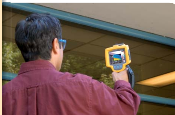
Rivestimento di tetti: rilevamento di punti con infiltrazioni d'acqua in strutture con tetto piano per individuare aree con rivestimento danneggiato.
